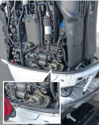
4. Führen Sie den Kreuzschlitzschrauben dreher mit dem Griff des Werkzeugsatzes in die Öffnung des Schaltaktuator's ein.
